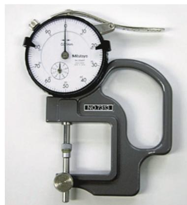
FIGURA 3 - Medidor de espessura.
