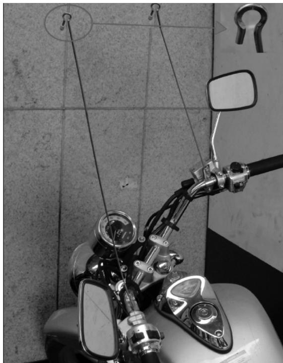
**Figura 5** - Antena instalada em motocicleta (no detalhe, o gancho).
