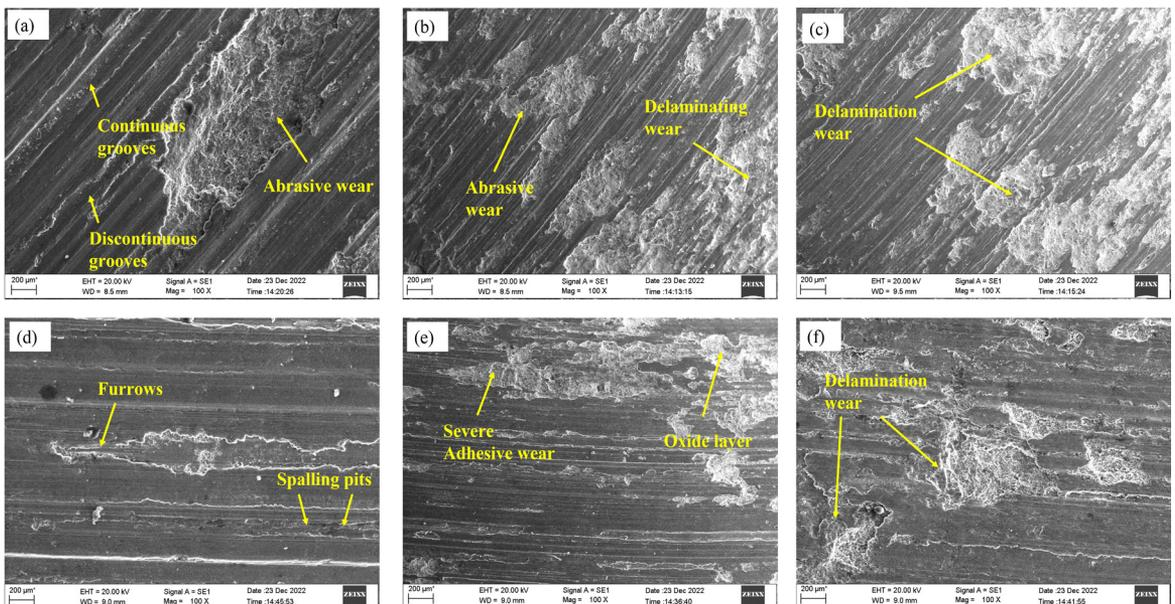
Figure 15. Worn surfaces of C1 composite (a)~(c) (a) 20 N, (b) 40 N, (c) 60 N. Worn surfaces of C2 composite (d) ~ (f): (d) 20 N, (e) 40 N, (f) 60 N.
