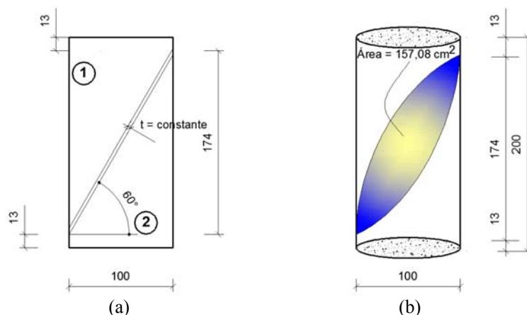
**Figura 10:** Corpo de prova com união a  $60^\circ$ : a) seção transversal; b) dimensões (medidas em mm).
