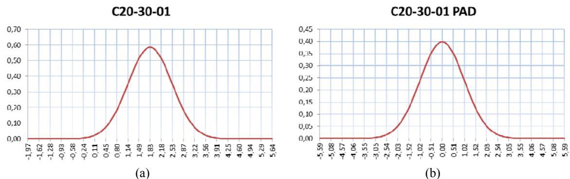
**Figura 15:** Distribuições normais para C20-30-01: (a) rugosidade em mm; (b) normalizada.
