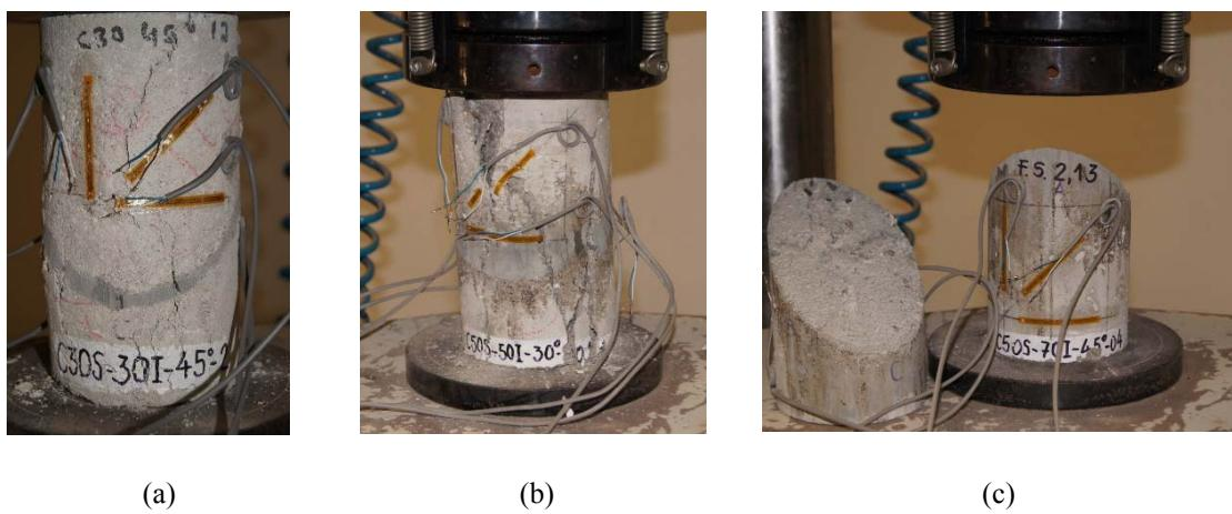
**Figura 18:** Rupturas dos corpos de prova: (a) comportamento monolítico na ruptura para corpos de prova de concreto de resistência normal e qualquer inclinação; (b) comportamento monolítico na ruptura para corpos de prova de concreto de alta resistência e inclinação de 30°; (c) comportamento monolítico na ruptura para corpos de prova de concreto de alta resistência e inclinações de 45° e 60°.
