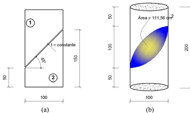
**Figura 9:** Corpo de prova com união a  $45^\circ$ : a) seção transversal; b) dimensões (medidas em mm).
