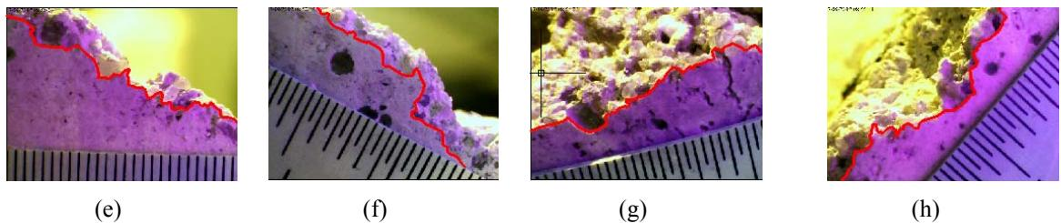
**Figura 13:** Ampliação de 20 vezes sem contorno: (a) C20-45-02-A; (b) C20-45-02-B; (c) C20-45-02-C; (d) C20-45-02-D. ade 20 vezes com contorno: (e) C20-45-02-A; (f) C20-45-02-B; (g) C20-45-02-C e (h) C20-45-02-D.
