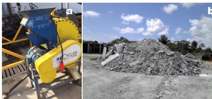
**Figura 1:** (a) Britador; (b) Pilha de resíduos de concreto separada para o programa experimental.
