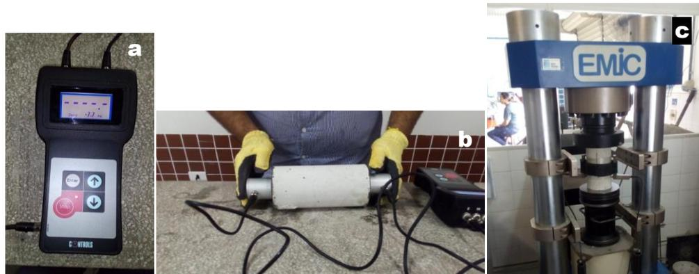
Figura 2: (a;b) Ultrassom e o ensaio de MED; (c) Prensa utilizada no ensaio de MEE
