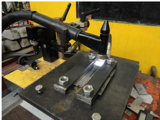
**Figura 1:** Montaje experimental para soldadura PAW.
