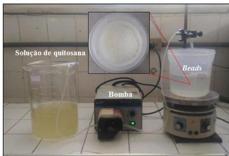
**Figura 1:** Sistema de gotejamento para produção dos *beads*.
