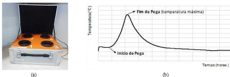
**Figura 2:** Ensaio de calorimetria: (a) calorímetro semi-adiabático e (b) exemplo de curva de calor de hidratação gerada.
