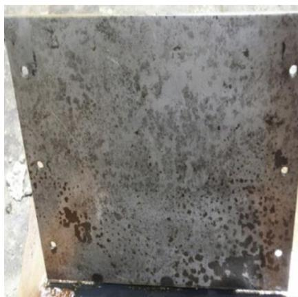
**Figura 3:** Manchas na superfície do elemento de concreto (Fonte: LIBESSART *et al.*, 2015 [9]).
