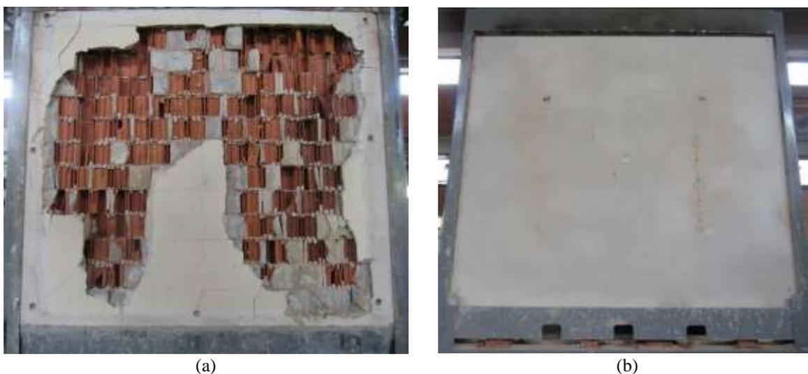
**Figura 8:** Aspecto final da parede: (a) superfície exposta e (b) superfície não exposta.
