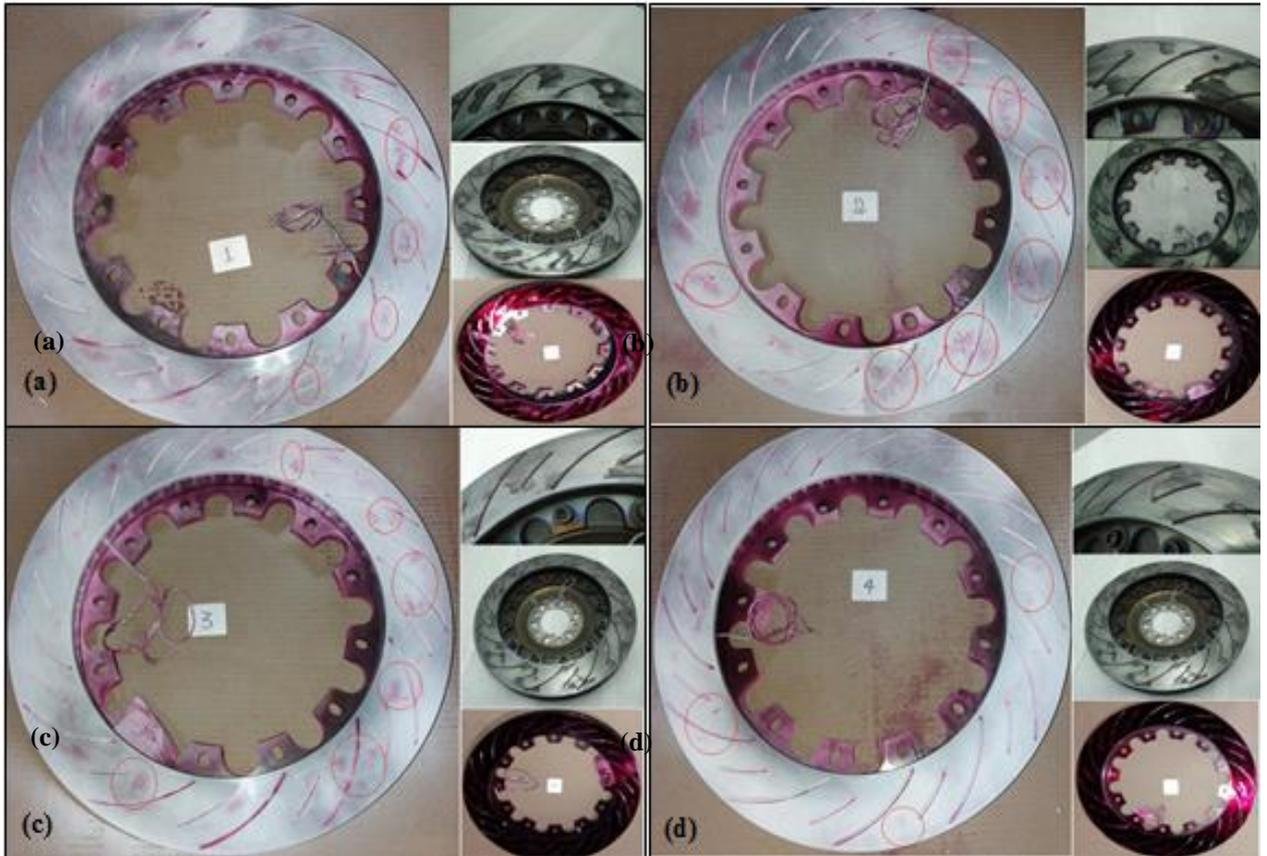
**Figura 8:** Análise de trincas por líquido penetrante: (a) disco 1, (b) disco 2, (c) disco 3 e (d) disco 4.
