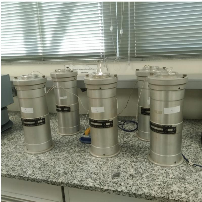
**Figura 9:** Calorímetro utilizado nos experimentos.
