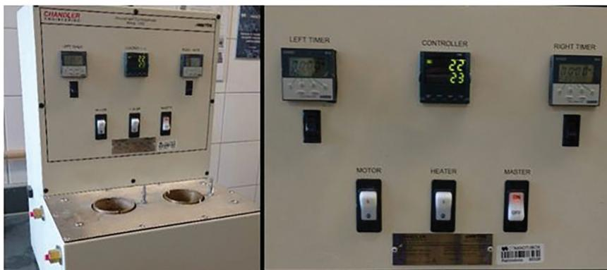
Figura 8: Consistômetro atmosférico utilizado na homogeneização das pastas: à esquerda o perfil do equipamento e à direita o painel de controle.
