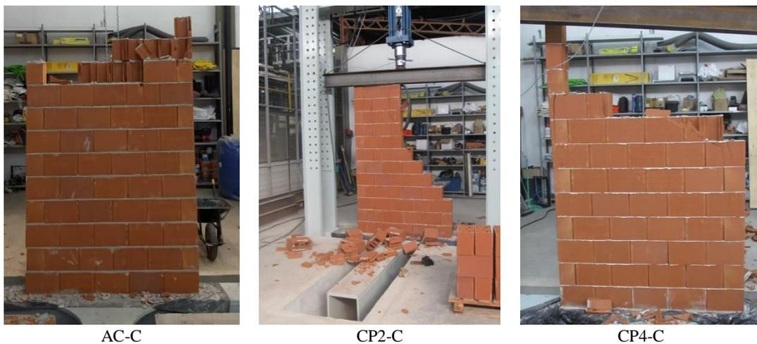
**Figura 10:** Condições físicas das amostras após realização do ensaio de compressão axial
