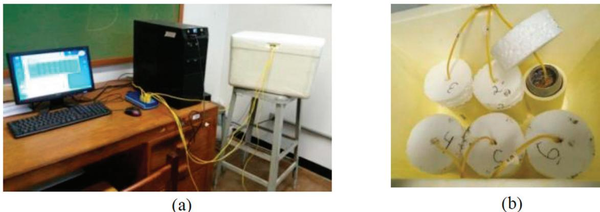
**Figura 3:** Aspecto do ensaio montado para avaliar a interferência das fibras kraft no processo inicial de hidratação do cimento Portland, com o sistema coletor de dados ligado a um computador e a caixa térmica com as amostras conectadas para acompanhamento da evolução da temperatura das pastas (a). Vista da caixa térmica de isopor, com os seis corpos de prova armazenados em seu interior, prontos para o início do acompanhamento da evolução da temperatura (b).
