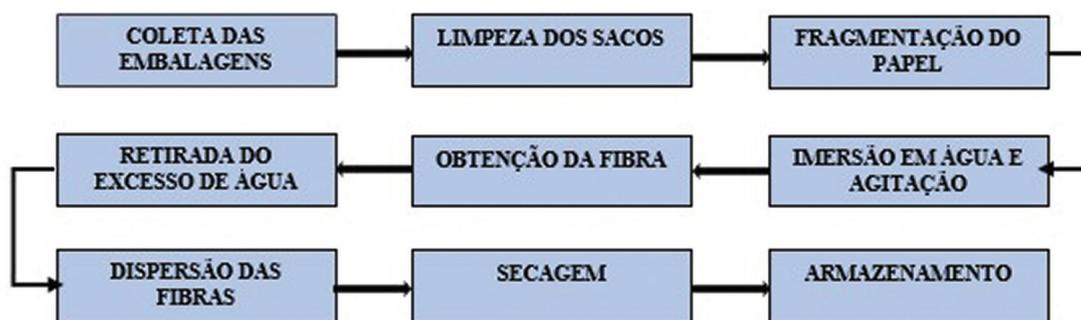
**Figura 1:** Fluxo com as principais etapas do processo de reciclagem das embalagens de cimento Portland, coletadas em canteiros de obras, para obtenção das fibras kraft dispersas para utilização na matriz cimentícia ALVES [11].
