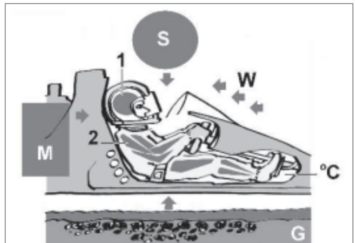
**Fig. 1** – Diagrama do ambiente da cabina (cockpit) durante a corrida – Fontes externas de calor: S, solar; M, mecânica; G, do terreno; W, da massa de ar. Fontes internas de calor: 1, metabolismo cerebral; 2, atividade física muscular.
