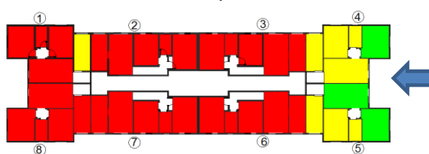
Figura 27 - Escala cromática de velocidades médias - tipo 3 - vento 90º
