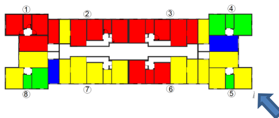
Figura 29 - escala cromática de velocidades médias - tipo 3 - vento 135°
