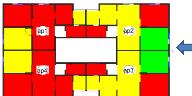
Figura 21 - Escala cromática de velocidades médias - tipo 2 - vento 90°
