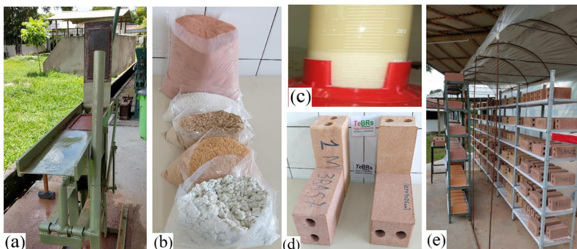
Figura 5 - Processo de produção dos TeBR - (a) Nova prensa manual; (b) barro, areia, cinza, serragem e fibra de papel; (c) manípueira; (d) TeBR com as posições de paredes (90 mm e 115 mm); e (e) secagem na sombra
