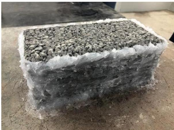
Figura 8 - Agregado graúdo utilizado para o sistema simulador de drenagem
