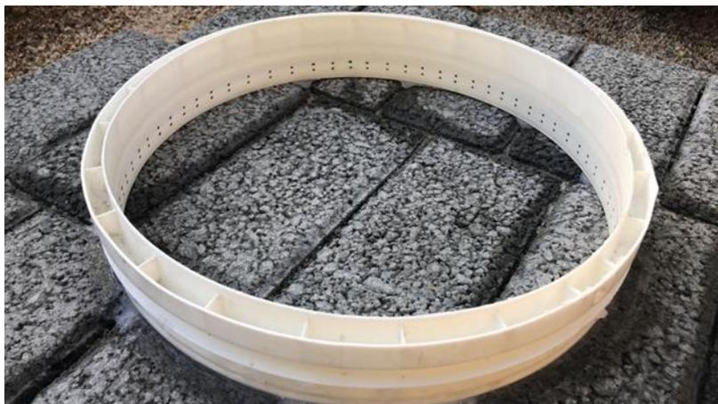
Com o sistema concluído, o teste foi executado. Este consiste em, primeiramente, executar uma pré-molhagem no sistema de 30 segundos. Após a pré-molhagem, despejar controladamente 3,6 litros de água e manter o seu nível dentro das marcações indicativas no interior do anel cilíndrico, marcando o tempo necessário para completa infiltração, com um cronômetro de resolução de 0,1 segundos.
