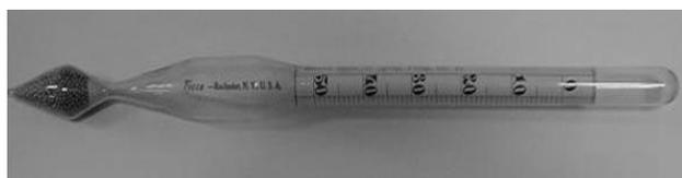
Figura 11 - Densímetros para líquidos mais densos que a água ( $d = 1,00 \text{ a } 1,50$ ); o elemento de equilíbrio são bolas de chumbo seladas com algodão. O formato da ampola não é cilíndrico, e pouco se destaca em relação à haste. Fabricado nos Estados Unidos em 1943.
