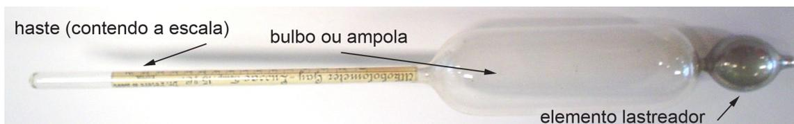
Figura 2 - Esquema clássico de um densímetro. O lastro se localiza na parte inferior do instrumento.
