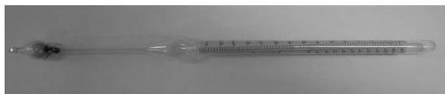
Figura 9 - Densímetro de uso geral de escala dupla para líquidos mais densos (1,0-1,5, escala inferior) ou menos densos (0,7-1,0, escala superior) que a água; seu elemento de equilíbrio é o mercúrio. Fabricado na Alemanha no início do século XX.
