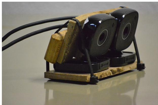
Figura 5 - Montagem de duas câmeras de computador para visualização 3D.
