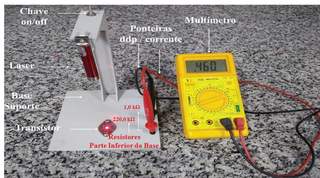
Figura 1: Protótipo para estudo do efeito fotovoltaico e a Primeira Lei de Ohm.
