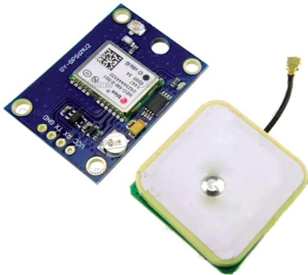
**Figura 4:** Módulo GPS NEO-6M utilizado para a geolocalização da radiossonda. **Fonte:** Dos autores.
