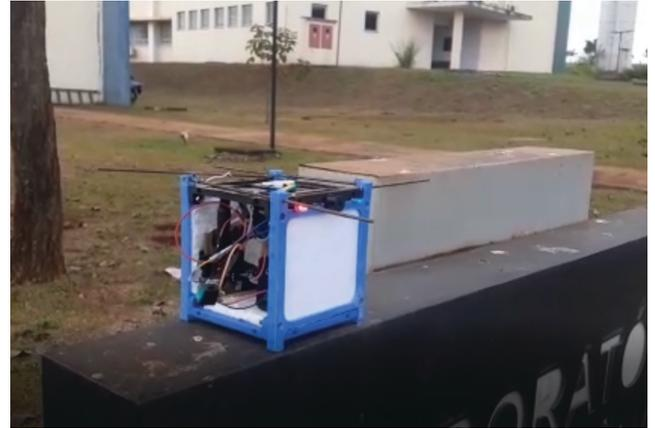
**Figura 2:** Radiossonda construída no formato de cubosat fazendo teste de comunicação em RF. **Fonte:** Dos autores.
