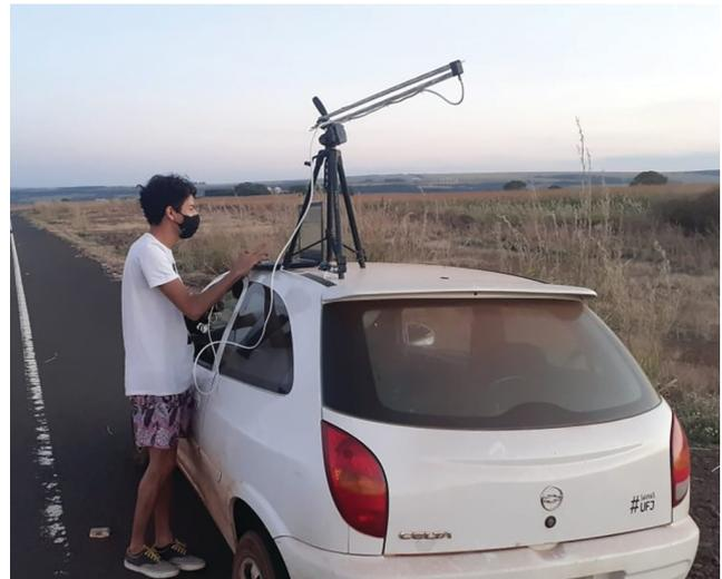
**Figura 6:** Teste de comunicação RF em solo. Nota-se na imagem a antena YAGI utilizada neste projeto.
