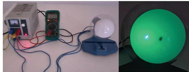
**Figura 11:** Experimento de difração de elétrons. Fonte: realizado pelos autores (2021).
