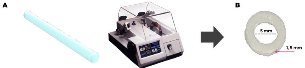
**Figura 2. Figura esquemática da confecção dos modelos circulares de polietileno.** (A) Tubos de polietileno foram seccionados transversalmente em máquina de corte Isomet 1000; (B) Obtenção de modelos circulares de polietileno com 5 mm de diâmetro interno e 1,5 mm de espessura.
