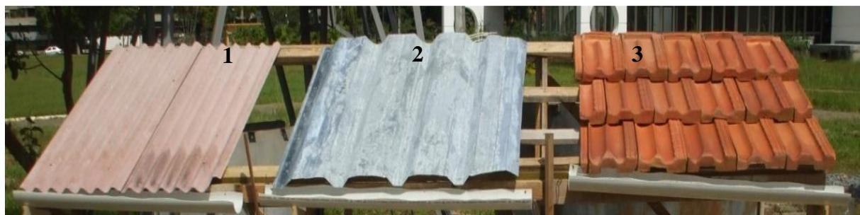
**Figura 1.** Montaje experimental con superficies de (1) amianto, (2) zinc y (3) cerámica.
