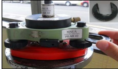
Na figura 5 (a) e (b) é possível visualizar um dos parafusos calantes travado (A) com a base desnivelada. Neste caso, o ponto A pertence ao plano  $\pi'$  e  $\pi$  (plano horizontal), enquanto os parafusos B e C pertencem ao plano  $\pi'$ . Já na Figura 5 (c) há a indicação da base nivelada com todos os pontos pertencendo ao mesmo plano.
