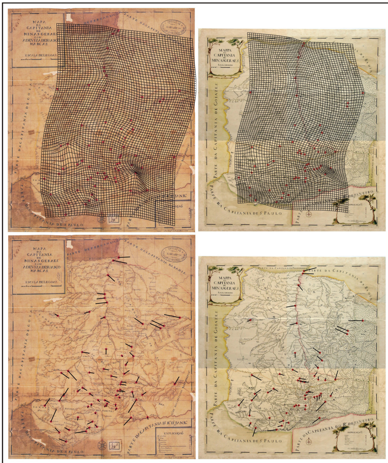
Figura 5. Rede de meridianos e paralelos implícita nos mapas de 1778 e 1793 em relação ao atual e o deslocamento de vetores.
