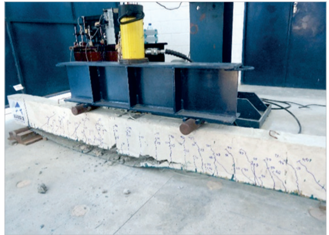
B Configuração da viga VB-2 na ruína
