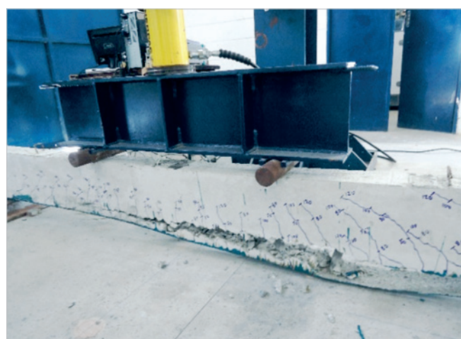
E Configuração da viga VA-5 na ruína
