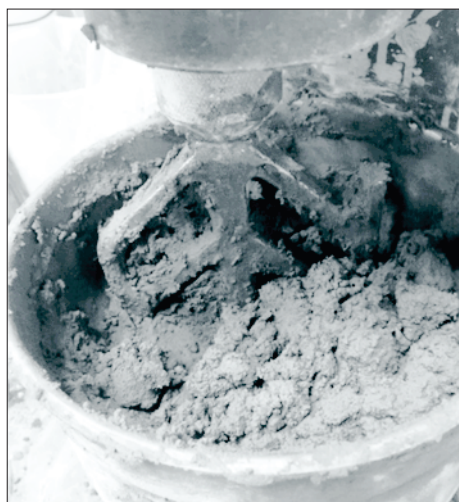
Figura 8 Pasta de sílica ativa, com relação a/s igual a 1 e teor de aditivo superplastificante igual a 3% m.c.
