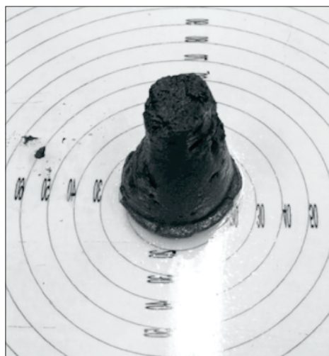
Figura 8 Pasta de sílica ativa, com relação a/s igual a 1 e teor de aditivo superplastificante igual a 3% m.c.
