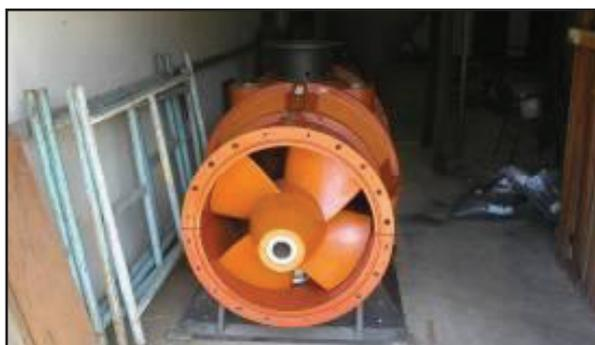
**Figura 3 - Turbina hélice no Laboratório de Turbomáquinas da UFPA**
