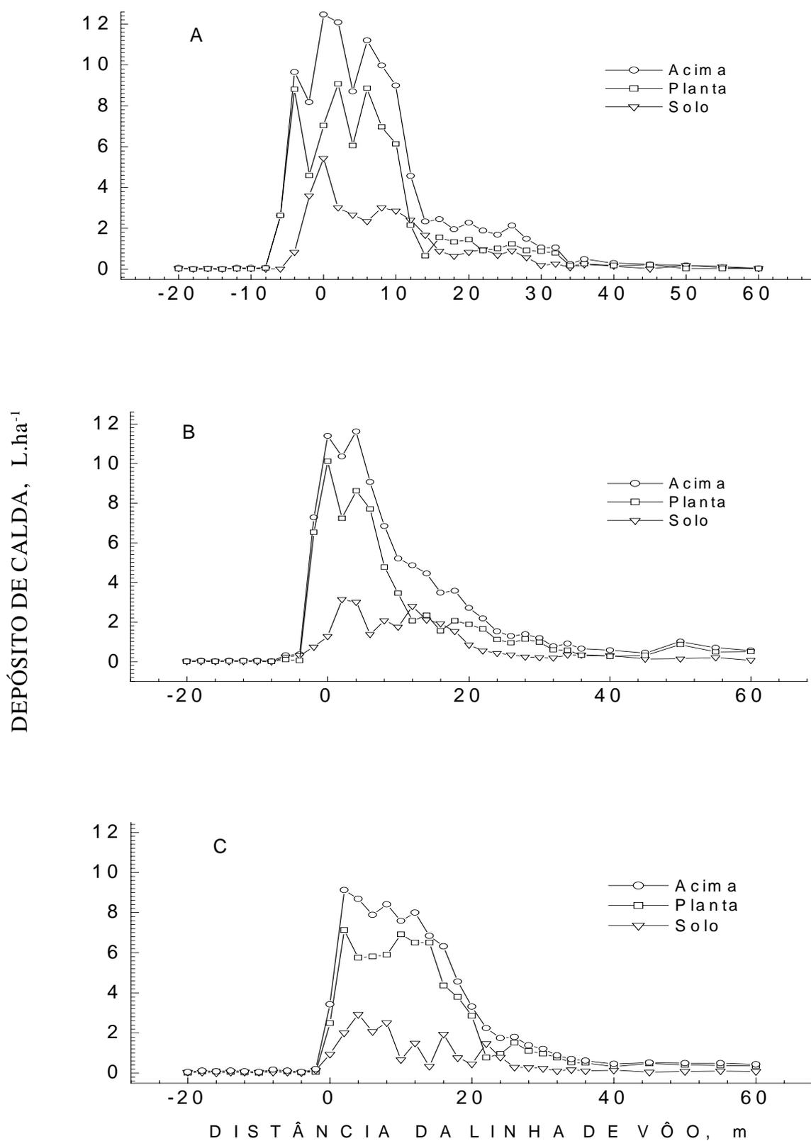
Figura 1. Depósitos de calda (L.ha<sup>-1</sup>) acima da cultura, nas plantas e no solo: A – 1ª aplicação, vel. do vento: 0,4 m.s<sup>-1</sup>; B – 2ª aplicação, vel. do vento: 1,2 m.s<sup>-1</sup>; C – 3ª aplicação, vel. do vento: 2,0 m.s<sup>-1</sup>.
