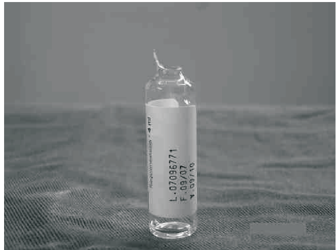
Figura 6 – Proyecciones Verticales en el Borde de la Abertura de una Ampolla de 4 mL.
