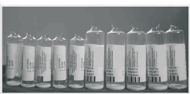
Figura 5 – Proyecciones Verticales en el Borde de la Abertura de las Ampollas de Propofol (10 y 20 mL).
