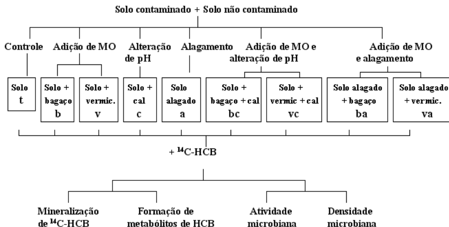
Figura 1. Diagrama esquemático de: tratamentos das amostras de solo contaminado com HCB; mineralização e formação de metabólitos de HCB em solo contaminado; atividade e densidade de microrganismos em solo contaminado com HCB.
