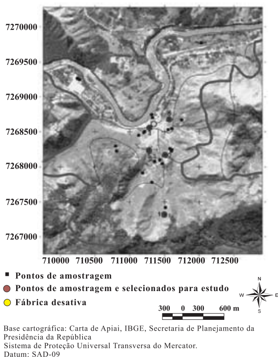
Figura 1. Foto aérea georreferenciada com os compartimentos geomorfológicos (linhas mais finas), localização da fábrica abandonada e locais de coleta (1, 2, 3, 5 e 6) dentro da área selecionada para o estudo (linha mais espessa). Os pontos menores representam a coleta prévia de solos para reconhecimento da área e definição dos ambientes em função das diferentes formas de contaminação, conforme detalhes apresentados por Andrade et al. (2009a).
