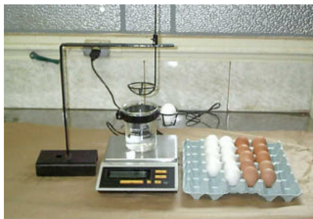
Figura 1. Aparelho de pesagem usado na determinação da gravidade específica dos ovos, segundo o princípio de Arquimedes.
