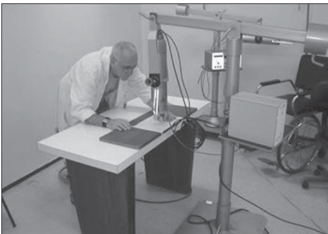
Figura 4. Levantamento das curvas de isocontagens do campo de visão do conjunto colimador-detector, para escolha da melhor distância entre o detector e a fonte de ^{131}\text{I} .
