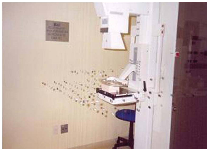
Figura 1. Fotografia mostrando a distribuição dos dosímetros em torno do mamógrafo, com o simulador de mama posicionado.
