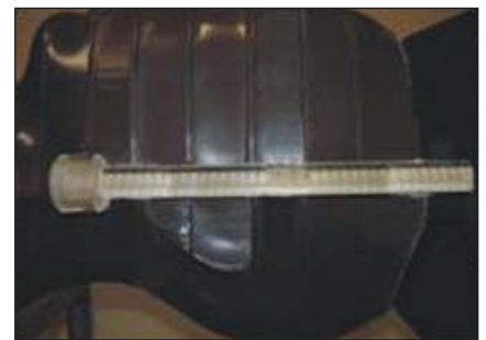
Figura 3. Foto da montagem do tubo de acrílico, contendo TLD-LiF, posicionado na lateral do fantoma.
