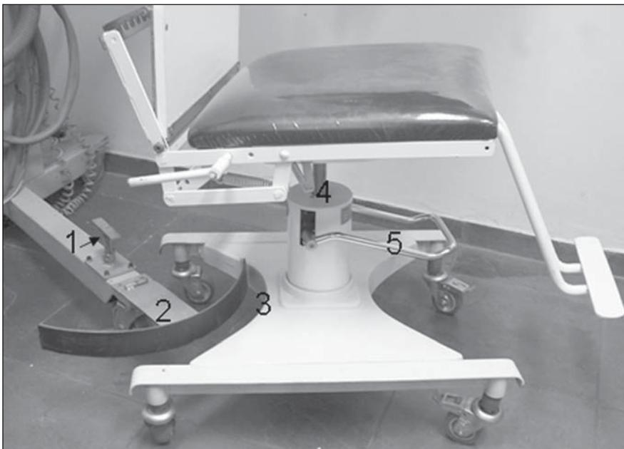
**Figura 3.** Em 1, parafuso de rosca sem fim para correção de desníveis. Encaixe recíproco com superfícies convergentes, convexas (2), côncava (3). Em 4, eixo hidráulico. Em 5, alavanca de mobilização e trava do eixo hidráulico.
