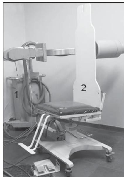
**Figura 1.** Em 1, base do equipamento radiológico "arco em C". Em 2, cadeira de base com eixo hidráulico para elevação e rotação a ser encaixada como complemento ao equipamento radiológico.
