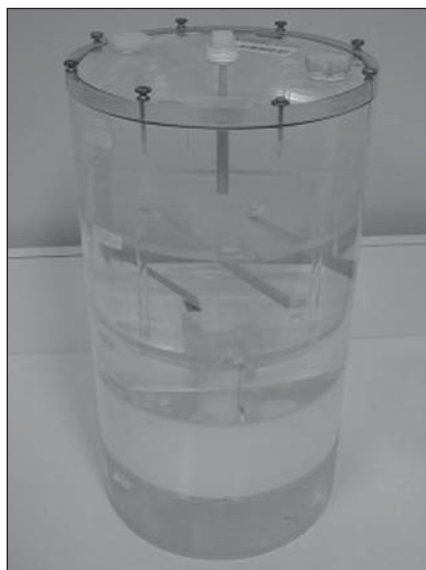
Figura 2. Simulador de qualidade para análise do ruído, contraste e resolução espacial da imagem.
