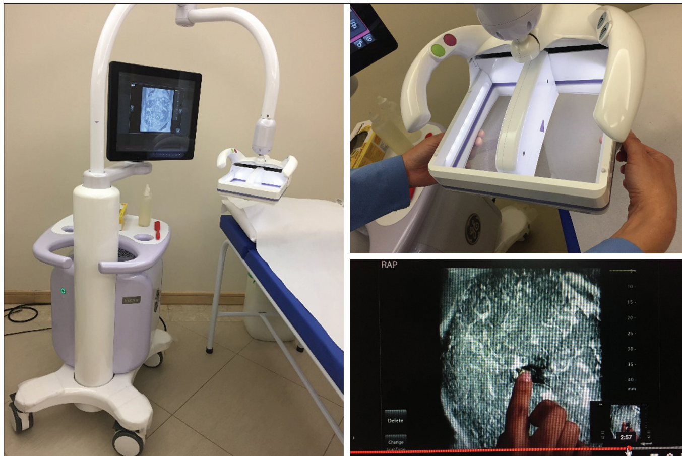
Figura 1. Equipamento utilizado neste estudo: ABUS. Transdutor com varredura automatizada e tela onde a técnica marca as incidências usadas e o mamilo.
