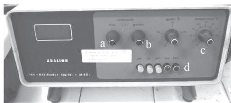
**Figura 4.** Peagâmetro digital, origem nacional, 1982, um dos primeiros modelos comerciais deste tipo: (a) ajuste de zero (grosso/fino); (b) ajuste de ganho; (c) seletor de temperatura; (d) seletores de escala. Dimensões: 36 cm de comprimento, 30 cm de largura e 20 cm de altura;  $m = 2,0$  kg
