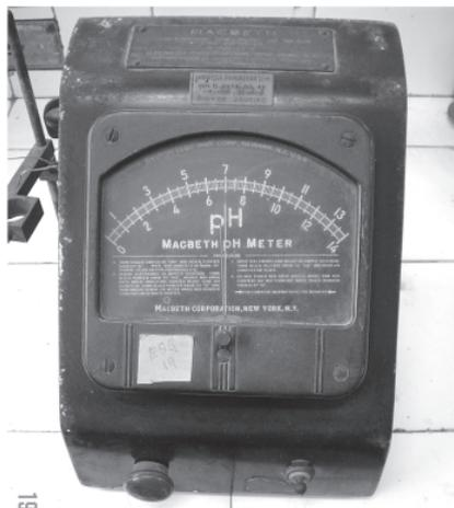
**Figura 2.** Peagâmetro de origem norte-americana, década de 1950. Seu visor apresenta duas escalas de pH alternadas: 1 a 13 (superior) e 2 a 14 (inferior). Dimensões: 24 cm de comprimento, 20 cm de largura e 16 cm de altura;  $m = 1,6$  kg. Acervo do Museu da Química Prof. Athos da Silveira Ramos
