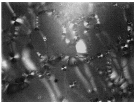
Figura 6. Fotomicrografia sob luz polarizada do sistema S_1 (silicone fluido de co-polímero glicol, poliéter funcional siloxano e água) 24 h após manipulação à temperatura ambiente ( 25 \pm 2^\circ\text{C} ) (400x)
