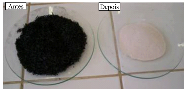
Figura 1. Sílica obtida da cinza da casca do arroz após 18 h de aquecimento em mufla a uma temperatura de 700 °C e lavagem com ácido clorídrico e água destilada
