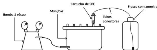
Figura 1. Equipamento de extração utilizando manifold
