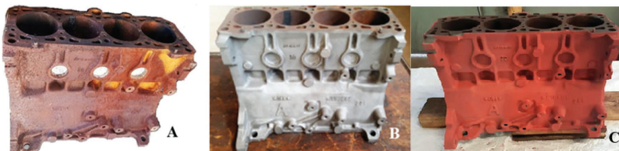
Figura 3. Superfície do bloco do motor de combustão interna oxidada (A), superfície do mesmo bloco do motor preparada para receber o revestimento por jateamento com granalha de aço - grau metal quase ao branco (B) e superfície após aplicação do revestimento protetivo (C)
