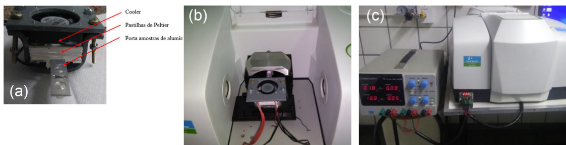
Figura 3. a) Suporte para o porta amostra de alumínio, b) sistema acoplado ao ATR e c) visão externa do sistema no espectrômetro
