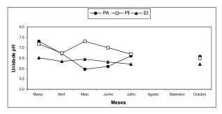
Figura 4 – Valores de pH da água de precipitação em aberto (PA), precipitação interna (PI) e escoamento pelo tronco (Et), observados na Mata do Paraíso, Viçosa, MG. 2004.
