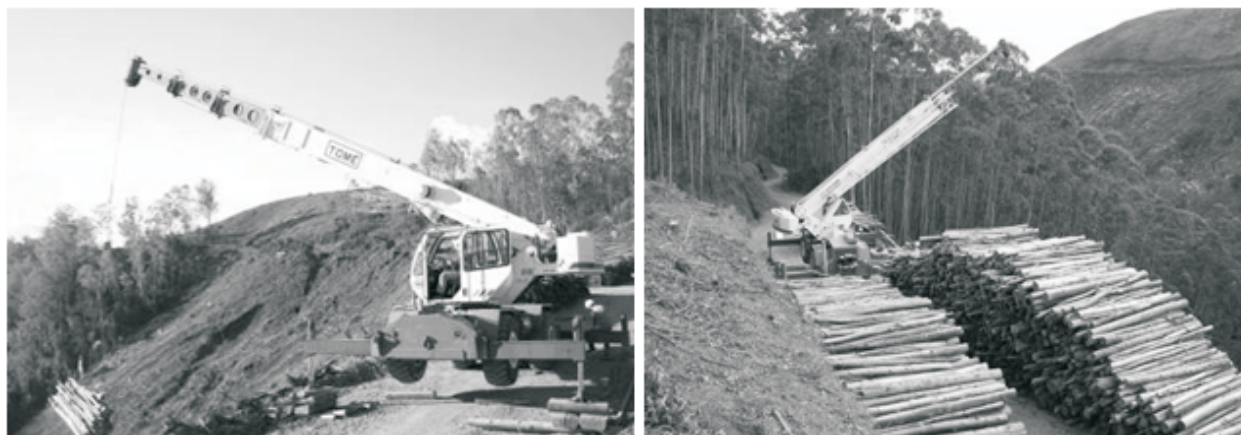
Figura 1 – Guindaste TEREX, modelo RT 230, em operação. Figure 1 – Crane TEREX, RT 230 model, in operation.
