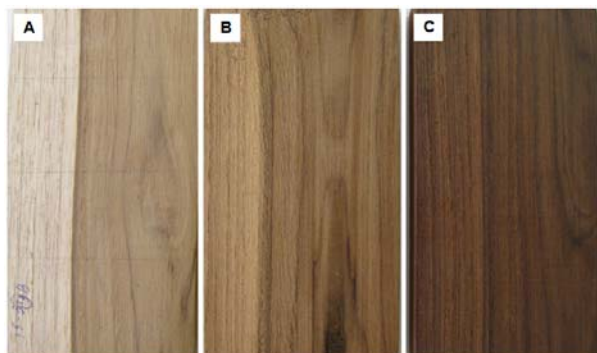
Figura 4 – Uniformidade da cor da madeira de teca, contendo cerne e alburno após os tratamentos termorretificadores. (A) Madeira original. (B) Madeira termorretificada a 180 °C. (C) Madeira termorretificada a 200 °C.
