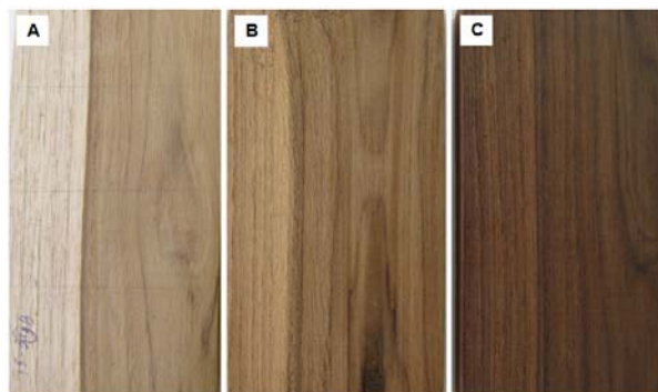
Figura 3 – Uniformidade da cor da madeira de teca, contendo cerne e alburno após os tratamentos termorretificadores. (A) Madeira original. (B) Madeira termorretificada a 180 °C. (C) Madeira termorretificada a 200 °C.
